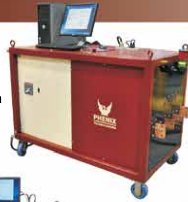
Equipo de prueba de reconector automático de 19 kVA
