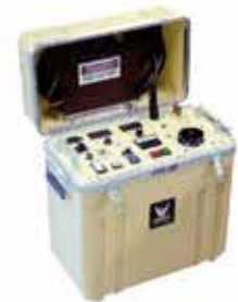
Alto voltaje de CC, 75 kV
