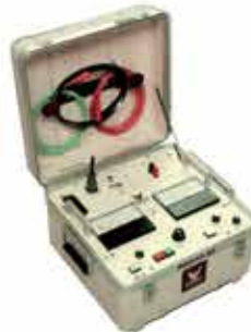
Alto voltaje/megaohmiómetro de CA/CC, 10/25 kV
