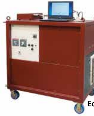
Equipo de prueba de reconector automático de 19 kVA
