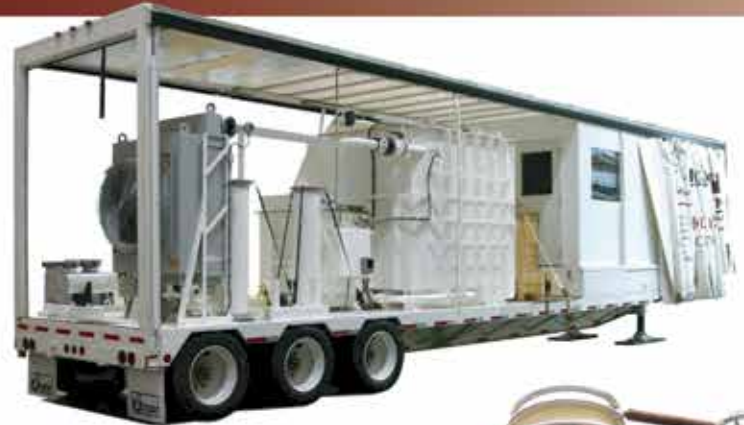
Frecuencia variable, 265 kV, 22 MVA
